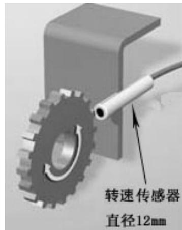
图 2-3 转速传感器安装示意图
